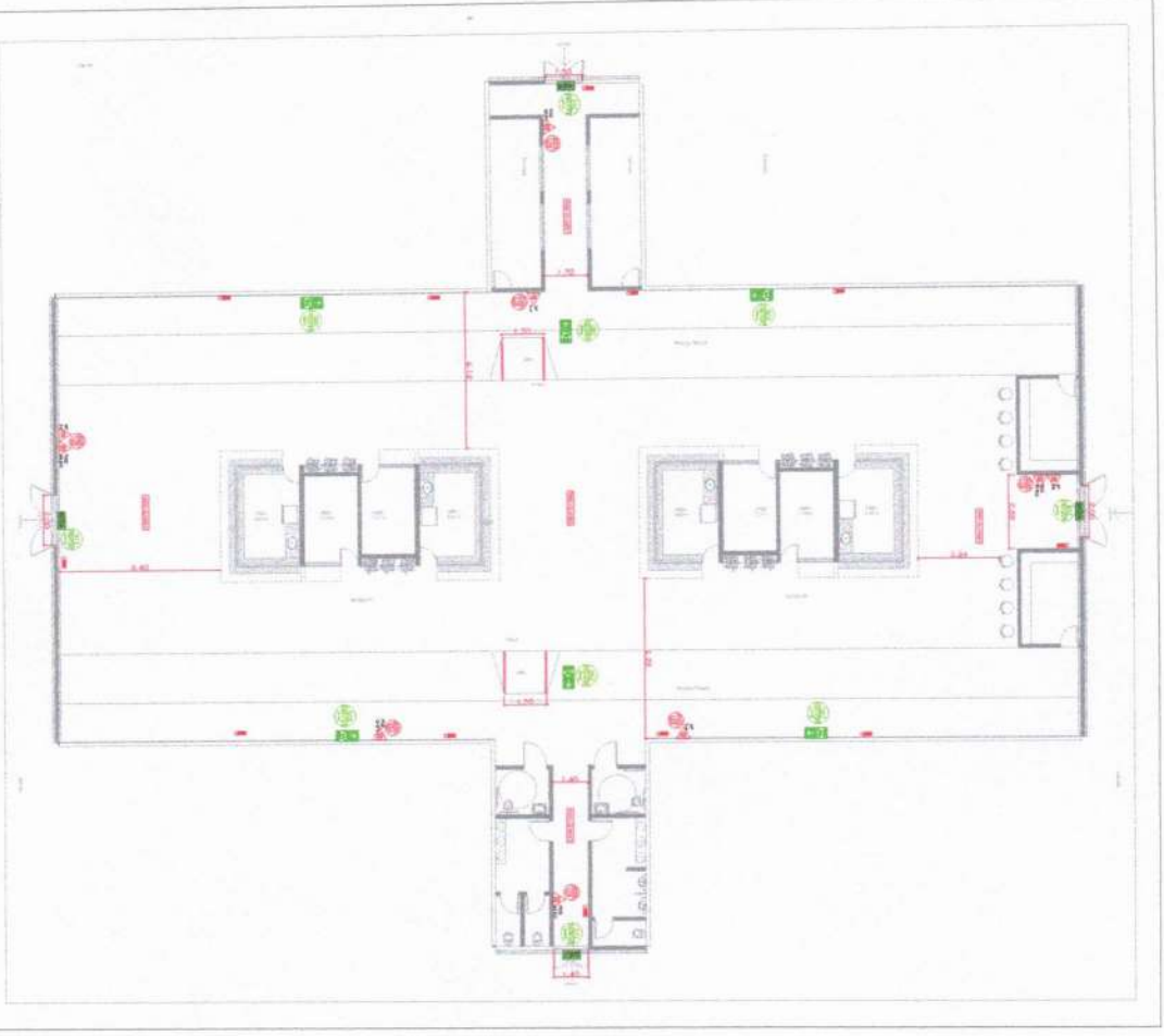
DETALHE DA ILUMINAÇÃO DE EMERGÊNCIA ESCALA 1/25
